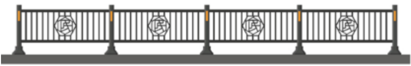
图 4.3-1 中央分隔带护栏示例
