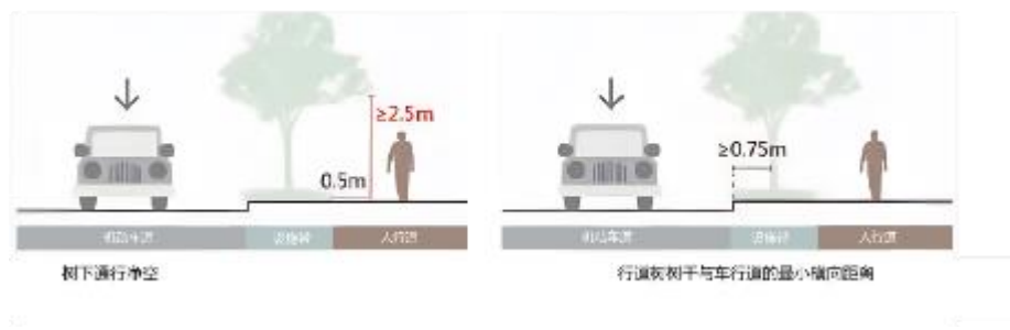
图 3.2-3 种植间距、横向距离、通行净空要求
