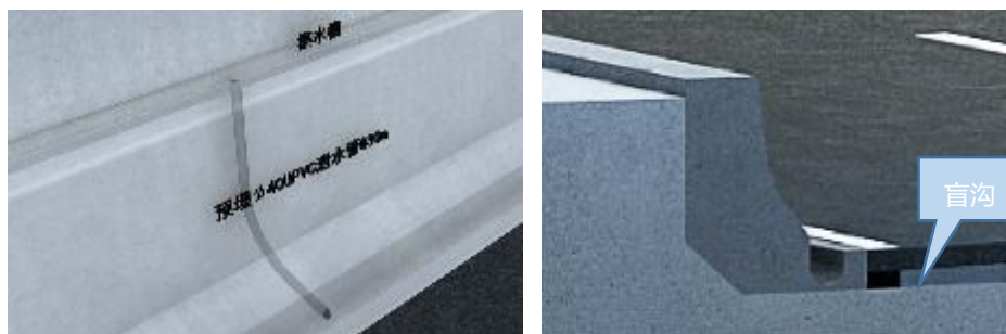
图 2.6-1 隧道防撞侧石及盲沟
