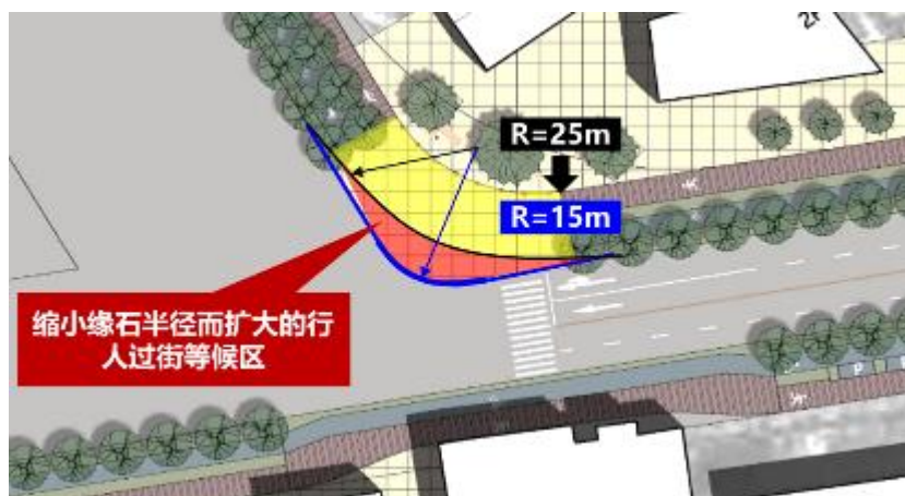
图 2.2-2 交叉口转角缘石半径设置示意图
